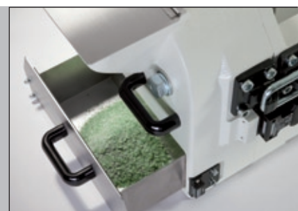
Broyat obtenu avec une largeur de fente de 1 mm
