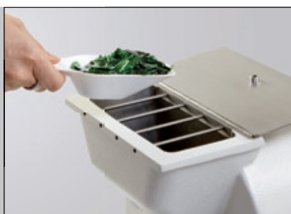
Remplissage de la trémie avec des morceaux de bouteille en verre concassées
