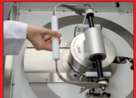
**Particulièrement sûr** : un excentrique symétrique développé par FRITSCH assure une fixation rapide et sûre de l'ensemble broyeur qui est supervisé en permanence. La position travail bien définie et une sécurité anti-forçage constituent un facteur de sûreté supplémentaire.
