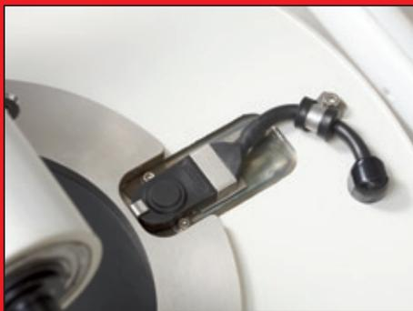
**Particulièrement intelligent** : un dispositif détecte automatiquement le type de garniture de broyage installée pour un broyage en l'absence de corps métallique, c'est à dire la présence d'organe de broyage en agate ou en oxyde de zirconium et réduit alors automatiquement la vitesse de rotation.
