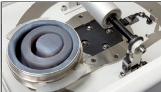
Pièce commandant la levée automatique de l'ensemble broyeur et contacteur de sécurité contrôlant la position.
