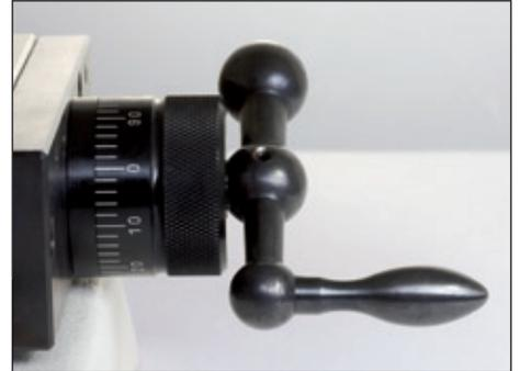
**Particulièrement précis :** le plateau coulissant de précision du broyeur à disques FRITSCH PULVERISETTE 13 permet un ajustement exact de l'écartement à 0,1 mm près – pour un traitement rapide, précis et dans des conditions reproductibles.
