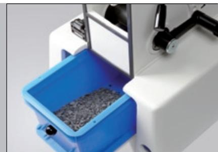
Broyage en force : traitement par le broyeur PULVERISSETTE 1 (modèle I) de roches basaltiques, écartement en position 2, à droite le broyat obtenu dans le récipient.
