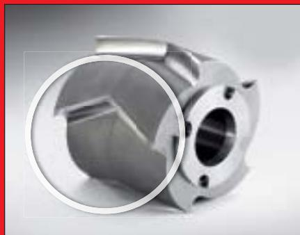
Le rotor standard en acier spécial avec lames en V et contre-couteaux convient tout particulièrement pour le traitement d'échantillons présentant une certaine élasticité, les films, les produits visqueux du fait de l'angle de coupe et des effets tranchants puissants mis en jeu. Pour les matériaux durs le rotor avec lames en V et contre-couteaux en carbure de tungstène est recommandé : l'échantillon est pulvérisé par effet d'impact et de coupe.
