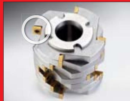
Le rotor à fraise particulièrement robuste avec plaquettes de coupe interchangeables et contre-couteaux en carbure de tungstène effectue le broyage de déchets électroniques, de circuits imprimés contenant des fibres de verre et des éléments en cuivre. Encore une bonne idée de FRITSCH : sur le rotor à fraise disque les plaquettes de coupe peuvent être retournées 4 fois ou être remplacées une par une. L'usure ou la casse ne sont plus une raison d'avoir à racheter un ensemble rotor neuf complet !
