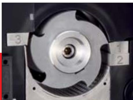
Une configuration de la chambre de broyage particulière : la chambre de broyage dans les broyeurs FRITSCH présente un volume mort réduit au strict minimum et une configuration de l'enceinte entre rotor et contre-couteaux avec un profil particulier assurant un processus de broyage efficace et rapide.
