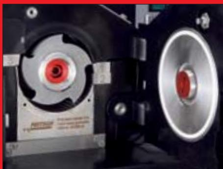
**Brevet FRITSCH** Sur les broyeurs à couteaux FRITSCH P-19 et P-25 le rotor est monté sur un double palier conique – sur l'arbre et dans le couvercle. Ce système assure un fonctionnement stable en régime dynamique, réduit fortement les effets d'usure et assure une grande longévité au matériel. Le modèle P-15 est aussi équipé d'un rotor à double palier.
