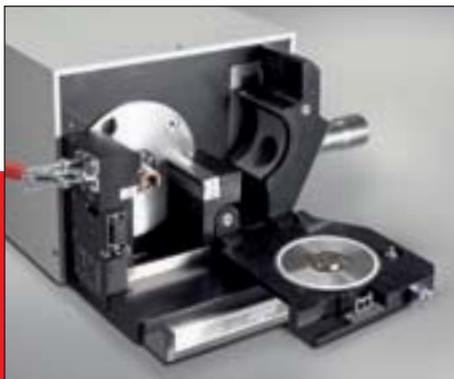
**Résultat** : une chambre de broyage complètement accessible, avec le minimum de volume mort, pour un nettoyage rapide et intégral, une sécurité absolue contre les contaminations croisées.
