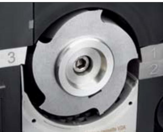
La configuration profilée de la chambre entre le rotor et les contre-couteaux assure un broyage rapide et empêche les colmatages.
