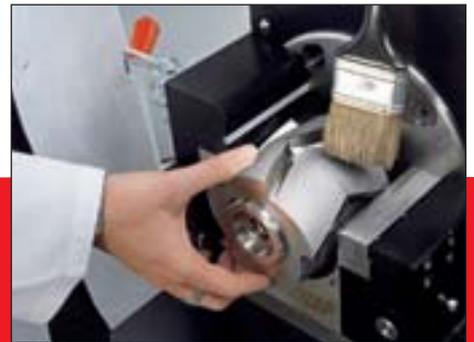
Le rotor des broyeurs à couteaux FRITSCH s'enlève sans aucune difficulté, pas d'outillage spécial à prévoir, et pour faciliter le nettoyage est prévue une commande de rotation en manuel lorsque le broyeur est ouvert.
