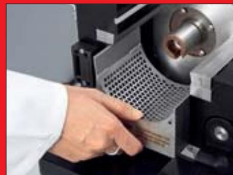
**Brevet FRITSCH** Les tamis FRITSCH sont extrêmement simples à installer et l'écart optimum par rapport au rotor est toujours assuré – la cassette à tamis FRITSCH est si pratique !
