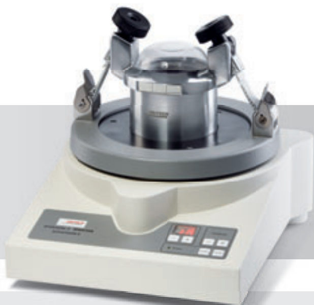
Broyage et tamisage en un seul appareil
