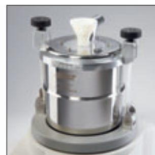
Enceinte cryogénique « cryo-box » de FRITSCH
