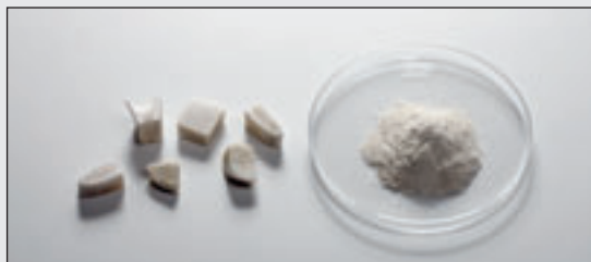
Échantillon de matières osseuses avant et après traitement par le broyeur PULVERISETTE 0 de FRITSCH
