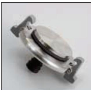
Le joint torique solidaire du couvercle assure une étanchéité absolument totale des bols de broyage *premium line*, aucune précaution supplémentaire n'étant à prendre pour les échantillons en suspension.
