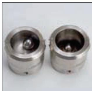
Les bols de broyage pour la PULVERISETTE 7 *prémium line* se déclinent dans des volumes de 20 ml, 45 ml et 80 ml. Tous les bols de broyage *prémium line* ont d'ailleurs le même diamètre intérieur – indépendamment de leur contenance. Avantage : la géométrie du bol de broyage n'interfère pas dans le rapport de vitesse.
