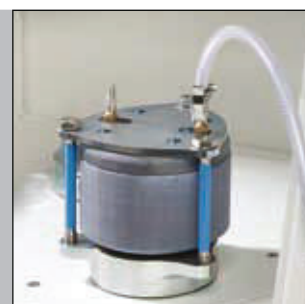
Le PULVERISETTE 4 pour le broyage sous gaz de protection
