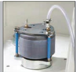
Le PULVERISETTE 4 pour le broyage sous gaz de protection
