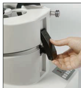
Arrêt de sécurité automatique en cas d'ouverture.
