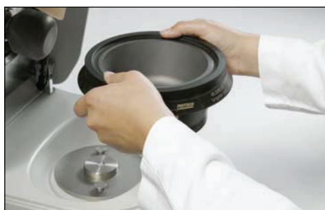
Simple à manier et particulièrement sûre : fixation à baïonnette rapide du bol du mortier.
