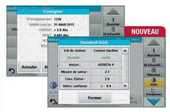
Filtres de test certifiés, solutions colorantes reproductibles standard ADDISTA et implémentation intégrée des mesures AQA (Assurance qualité analytique) pour assurer un niveau optimal de fiabilité.
