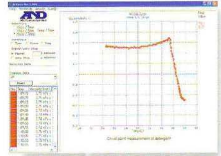
Mesure du point de trouble d'un détergent
