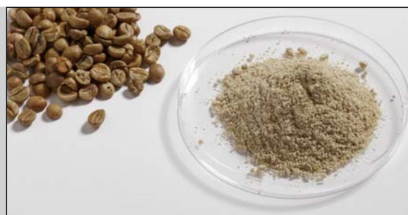
Café brut avant et après le broyage avec la P-14 à 20 000 tours /min et un tamis à passages trapézoïdaux de 1 mm
