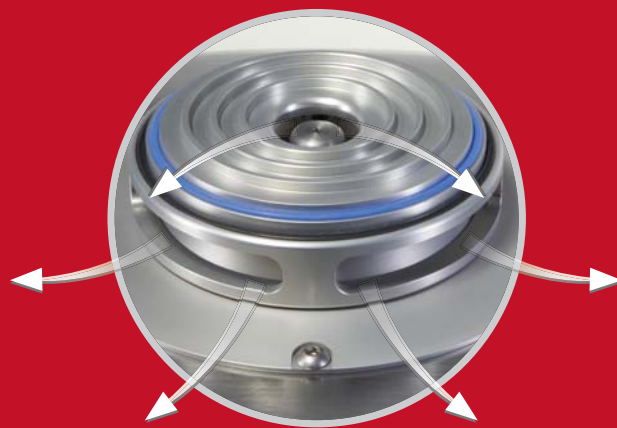
Circulation d'air très étudiée pour un refroidissement efficace de l'échantillon
