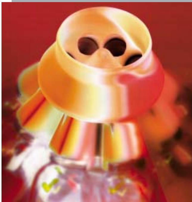
Grâce à la rotation de la tête de division, le nombre d'étapes de la division peut être augmenté jusqu'à 3000 phases par minute, si bien que chacun des échantillons se compose d'un très grand nombre d'échantillons individuels - le signe particulier caractérisant une division d'échantillons de qualité. Sa conception spéciale permet au diviseur d'échantillons à cône rotatif « laborette 27 » d'obtenir une division d'une précision jusqu'à 99,9 %.
