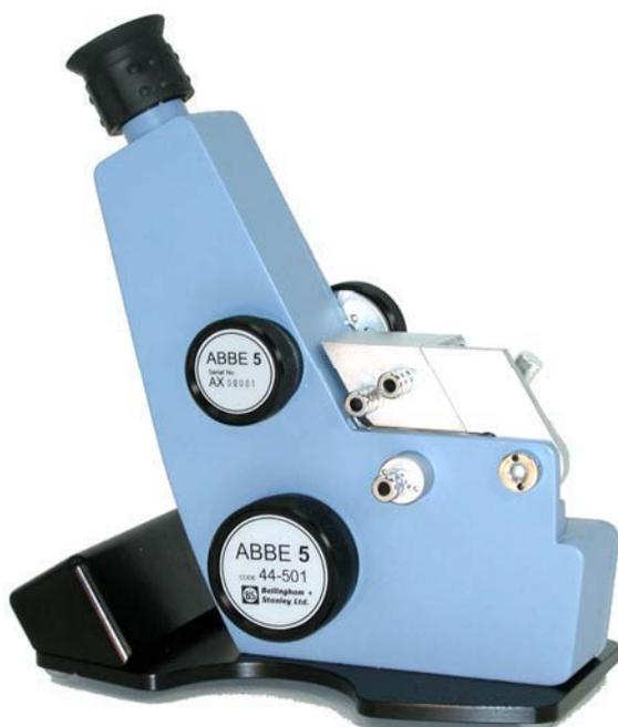
L'Abbe 5 est un refractomètre abordable et idéal pour des mesures d'un spectre large d'indices de réfraction (IR), qui sont exigées dans les laboratoires plus petits ou les laboratoires avec une quantité d'échantillons relativement basse. L'instrument est également idéal pour des démonstrations et des expériences pratiques dans des laboratoires de physique chimie d'écoles, de collèges et d'universités.
